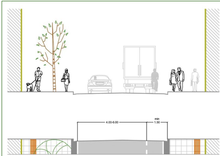
ΣΧΗΜΑ 2-4 Λωρίδα ποδηλάτων μη αποκλειστικής χρήσης. Τυπική διατομή
